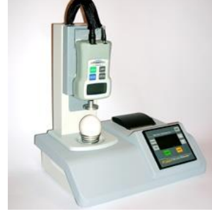
Otomatik kabuk kırılma direnci ölçüm cihazı (Newton)
