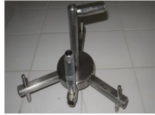
Yumurta ak ve sarı yüksekliği ölçümü (Üç ayaklı mikrometre)
