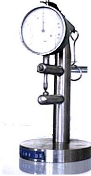
Mekanik yolla kabuk kalınlığı ölçer
