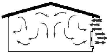
Şekil 6.31. Fan ve havalandırma açıklıkları aynı duvarda
