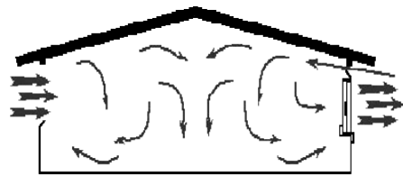
Şekil 6.32. Fan ve havalandırma açıklıkları karşı duvarda
