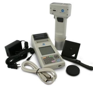
Colorimetre ile sarı ölçümü (Conica-Minolta CR-400)
